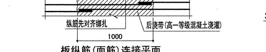
图5 楼(屋)面层后浇带做法
